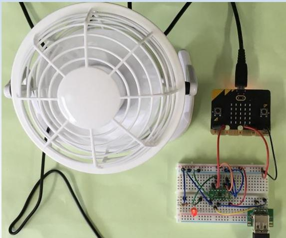
↑上の写真は micro:bit と電子回路を接続し、LED の点滅とモータを使った扇風機の回転を制御している様子です。
