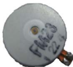
図 2 刺激振動モータとその仕様
