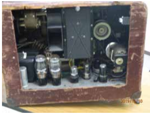
▲ 音声を再生する真空管アンプ
